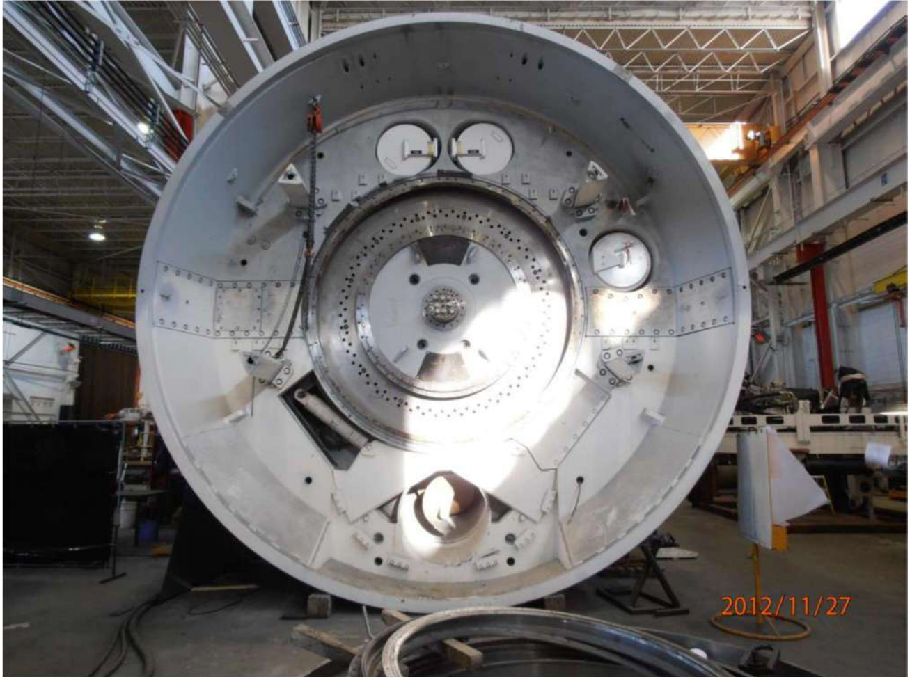
Şekil 6: Bir TBM'in ana tahrik ünitesi ve helezonunun önden görünümü
