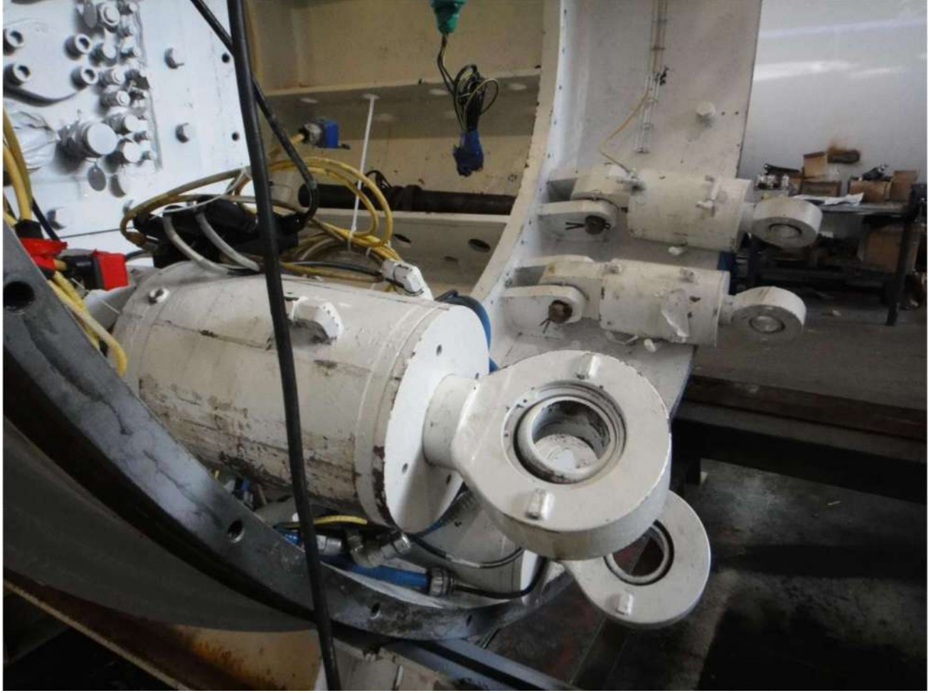
Şekil 31: Yönlendirme (Artikülasyon) Pistonları
