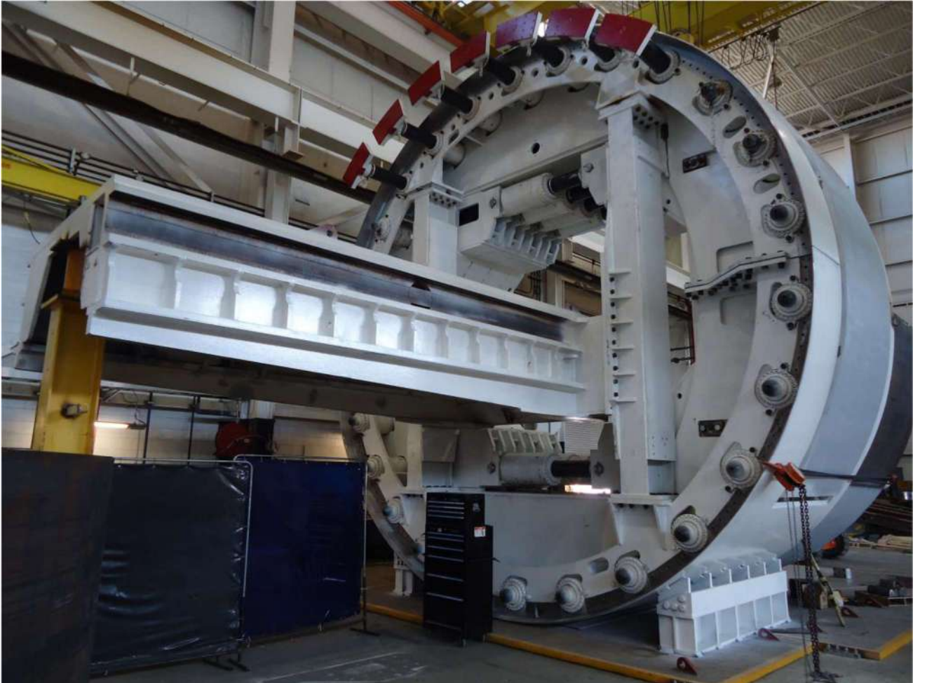
Şekil 7: Yapım halindeki bir TBM Orta Şilti
