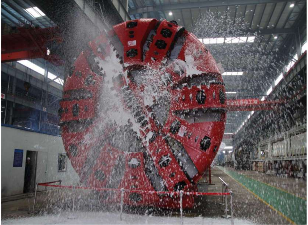
Şekil 13: Bir TBM'e ait köpük hattı testi
