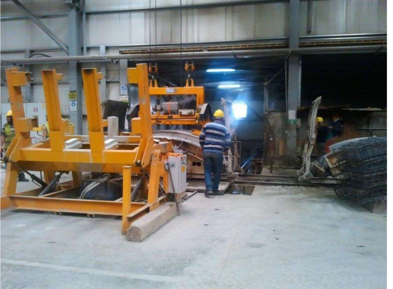
Şekil 37: Kürden çıkmış segmentin kaldırma aparatıyla kalıptan alınması ve devirme aparatı
