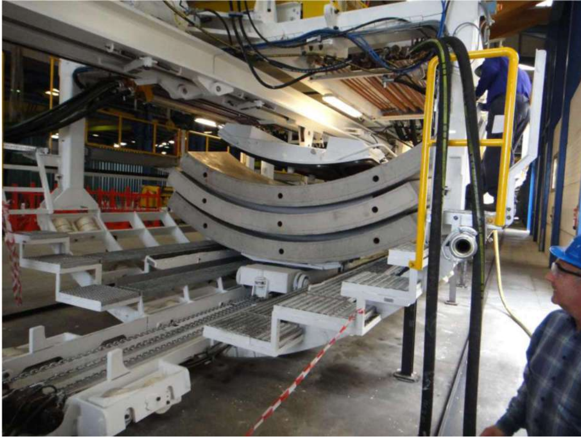
řekil 10: Vakumlu Segment Vinci ve Segment Nakliye nitesinde hazır segment tařları
